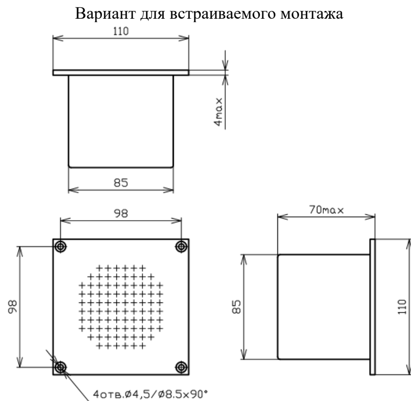
Рисунок А.33 - Габаритные размеры громкоговорителя 5ГП-1 для встраиваемого монтажа
